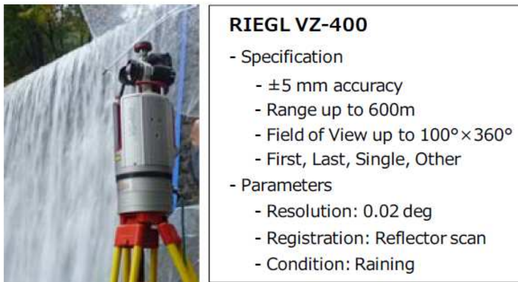
Fig. 7 Terrestrial LiDAR (RIEGL VZ-400)
